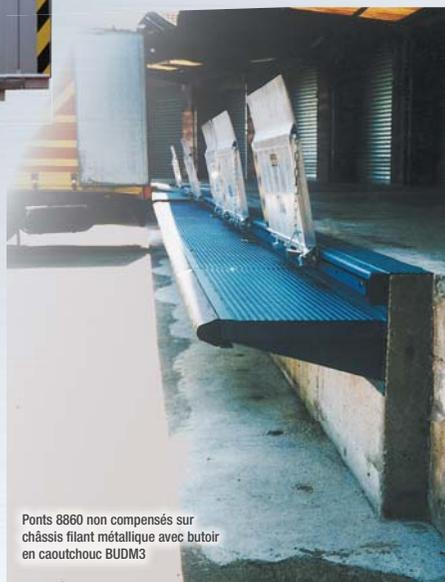
Ponts 8860 non compensés sur châssis filant métallique avec butoir en caoutchouc BUDM3
