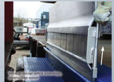
Verrou de blocage vertical automatique, déverrouillage manuel
