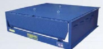
Le niveleur est entièrement caissonné sur 3 côtés qui sont munis de pattes de scellement. Il se pose sur un radier avec des fers à béton en attente sur les 3 côtés qui seront soudés sur les pattes de scellement puis remplis de béton.
